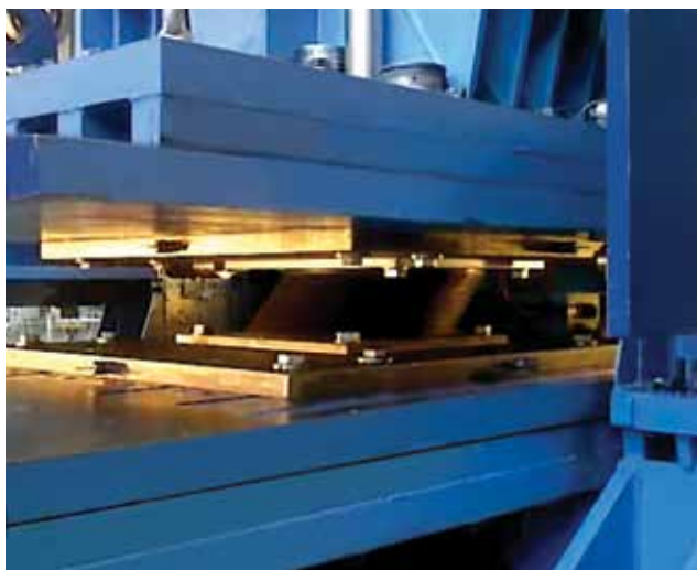
Aislador sometido a ensayo de deformación cortante dinámica
