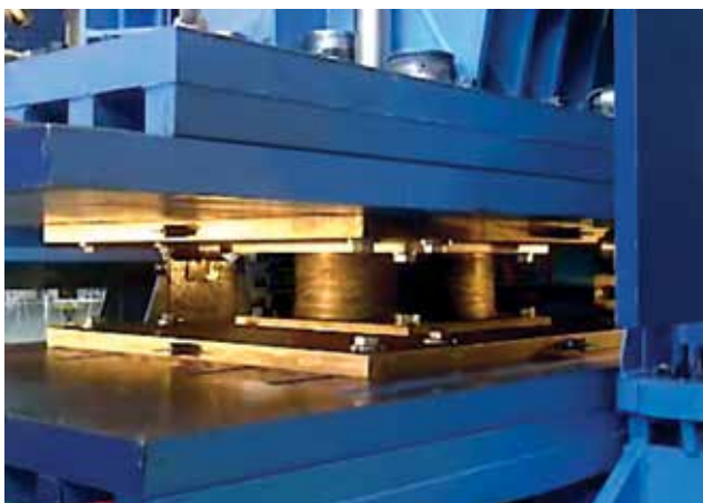
Aislador sometido a ensayo de deformación cortante dinámica
